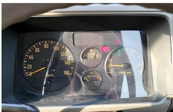
▼水温計、油温計ともに動作不良
