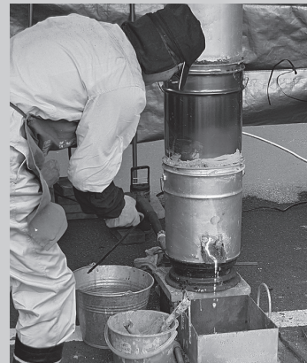
◀砂鉄を鉄に還元する際に出る不純物「ノロ」を排出する「ノロ出し」
