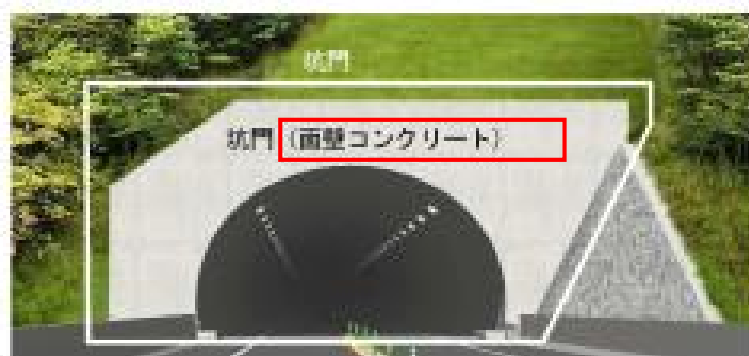
図3.2 トンネル本体工点検箇所
