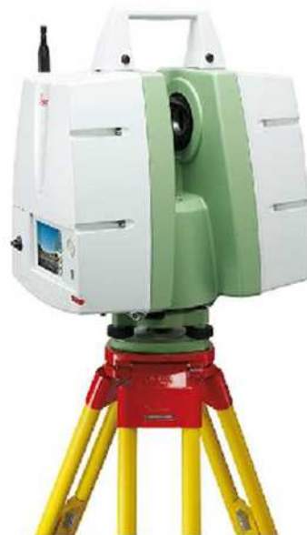
写真 5-3 ライカ社製 Scan Station C10
