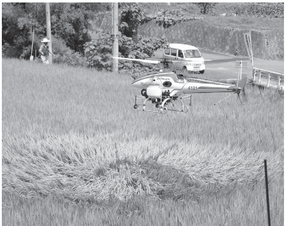
回転翼から拭きおろす強烈な風により農薬を葉裏や株元まで付着させる
