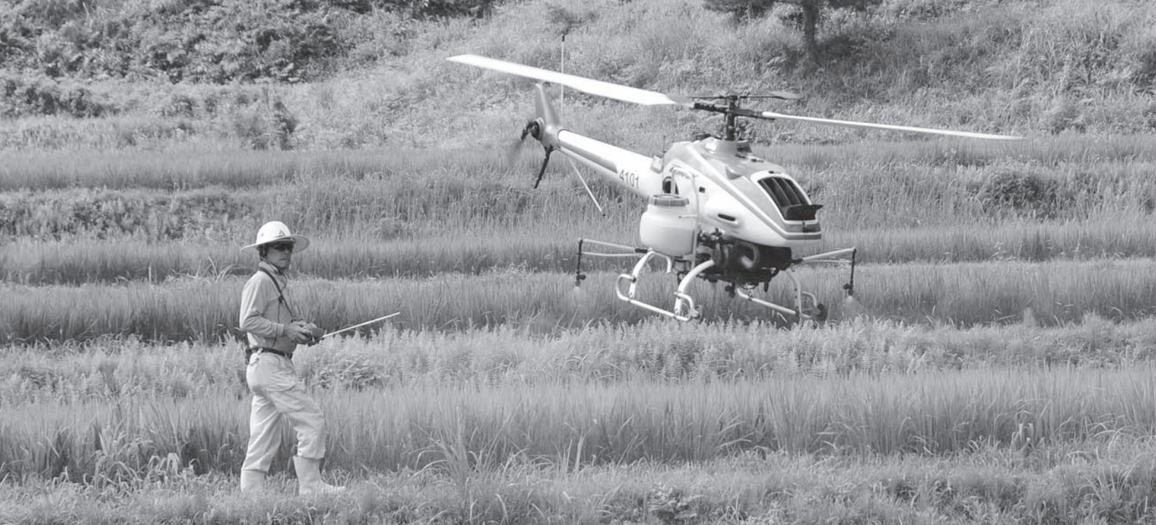
資格を持ったオペレーターが無人ヘリコプターを操作し、水稲の上を行き来させ農薬散布を行う
