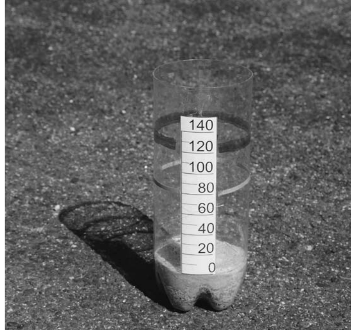
ペットボトルで作った簡易雨量計
